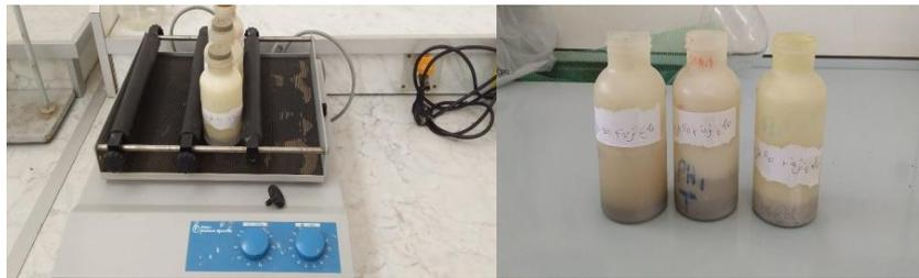
الصورة 3: وضع عينات التربة الثلاثة في جهاز الرج الكهربائي
