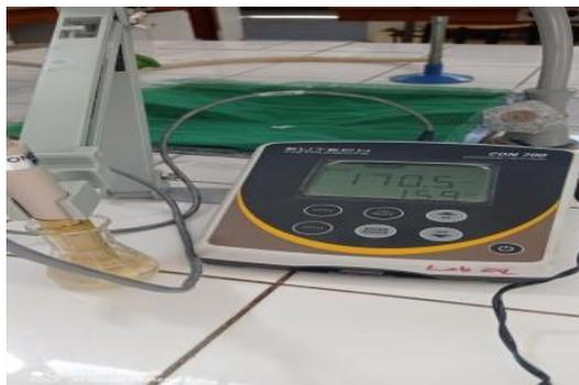
الصورة 7: جهاز قياس الناقلية الكهربائية
